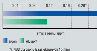
Średnia emisja ozonu przy ręcznym spawaniu metodą MIG blach ze stopu AlMg5 (przenoszenie natryskowe)
